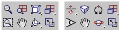
Abbildung 10.3.: Unterschiedliche Werkzeuge im Navigationsbereich rechts unten im MAX-Fenster für die jeweiligen Ansichten: Links für die orthogonalen Ansichten, rechts für die Kamera-Ansicht.
