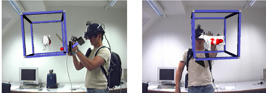
Abbildung 7: Ein Benutzer, der mit einem optisch erfassten Stift (Pinsel) arbeitet. Mit diesem Pinsel kann sowohl eine Farbe ausgewählt werden (links), als auch das Objekt mit gewählter Farbe bemalt werden (rechts) [11].
