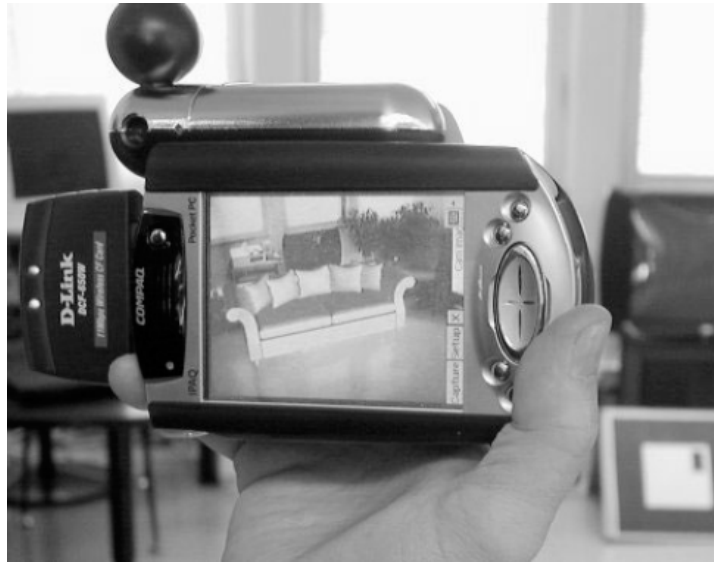
Abbildung 1: Hier wird ein Sofa in virtuell in einer realen Umgebung angezeigt. Der Marker (unter dem Fernseher) hilft der Software auf dem PDA zu erkennen wo sie sich im Raum befindet. Dadurch kann das Sofa korrekt gezeichnet werden. [2]
