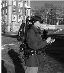
Abbildung 1 Aufbau des Systems mit Durchsichtsbatterie, Rucksack und PDA
