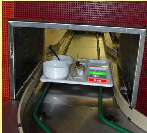
Die Tablett werden wie gewohnt abgegeben, kein Stau entsteht. Auslesen des RFID Tag während der Fahrt zur Spülmaschine
