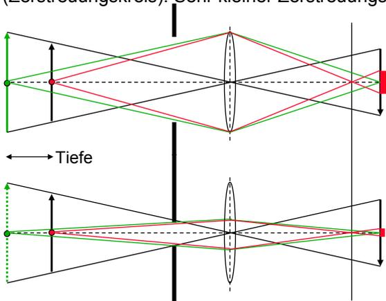
Bei kleiner Objektivöffnung verkleinern sich auch die Zerstreuungskreise: Der Bereich der (fast) scharf abgebildeten Objekte in der Tiefe der optischen Achse wird grösser.
