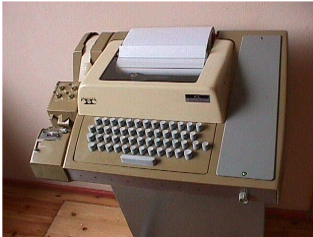
Abbildung 2: Fernschreiber wie der „Teletype 33“ wurden in der Mainframe-Ära zur Datenein- und -ausgabe verwendet
