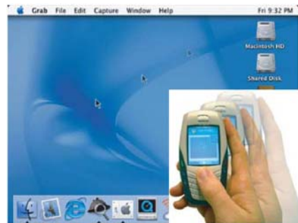
Abbildung 4. Rechts: Handy-Bewegung mit gedrücktem Joystick. Links: Bewegung des Mauszeigers am Bildschirm. (Quelle: [9])
